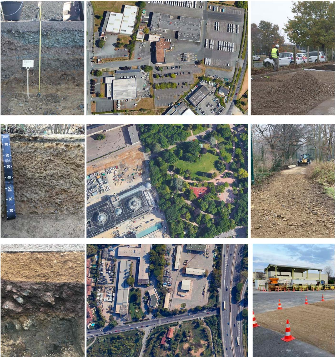
De gauche à droite : profils de sols scellés, vues aériennes des sites et mise en place des pilotes de terrain.
